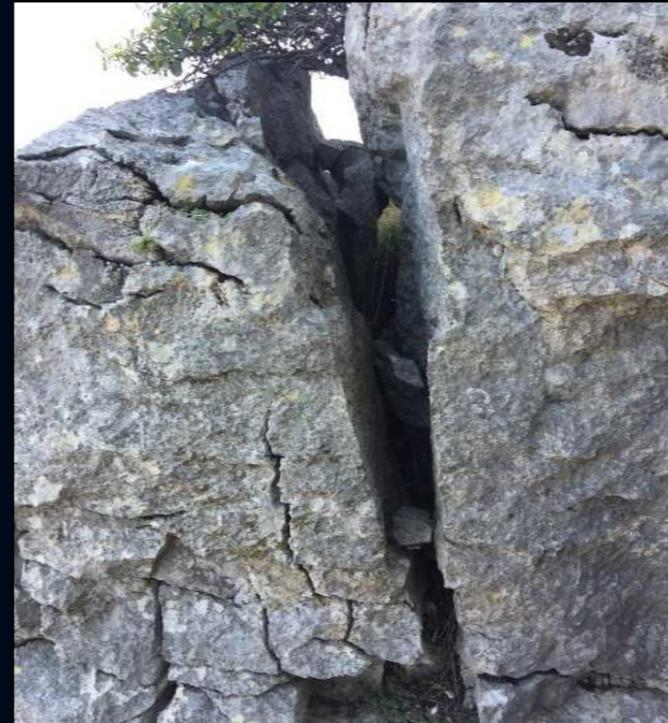
Particolare di un blocco isolato dalla discontinuità giacitura (**G**) che per azione meccanica delle radici, dell'acqua e di altri blocchi che vi finiscono al suo interno, provocano una rotazione predisponendo il blocco al **toppling** non per geometria delle discontinuità ma per azione erosiva.
