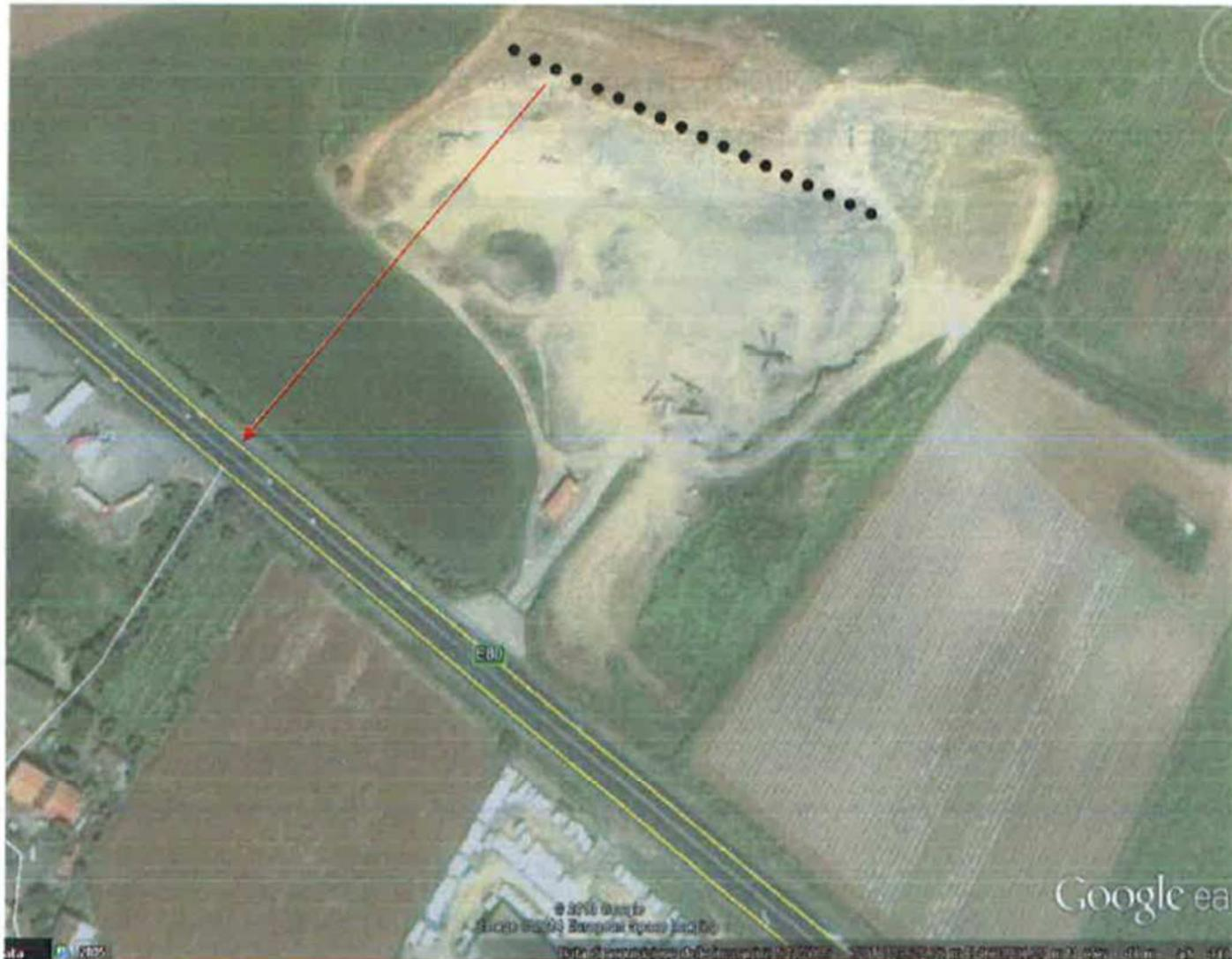
Ingrandimento vista secondo il quadrante Ovest con proiezione della linea di volata con la distanza minima di interferenza 200 ml.
