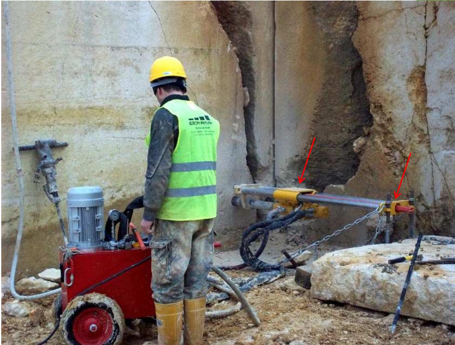
Perforatore idraulico servito da centralina elettrica
