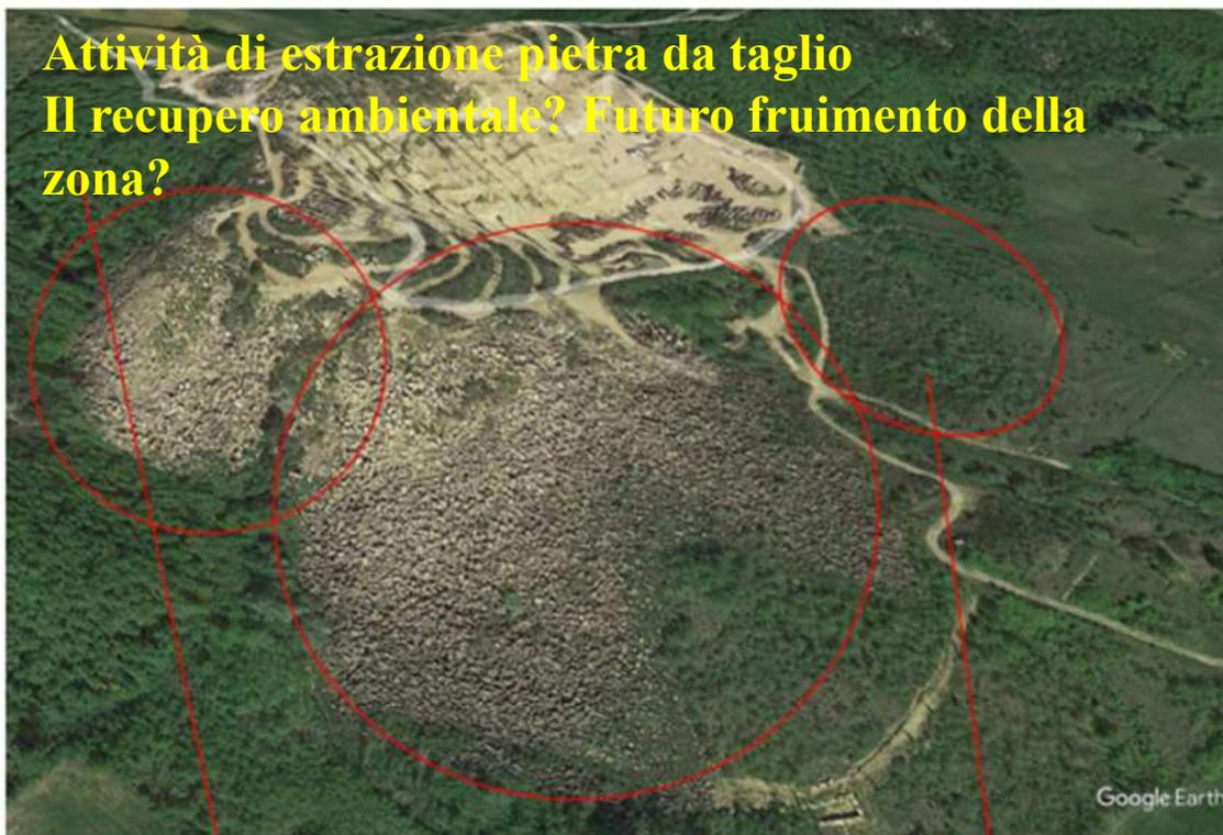
Imponenti volumetrie di blocchi scartati per mantenere la qualità di produzione. La superficie della discarica è ben oltre il doppio dell'area di cava.
