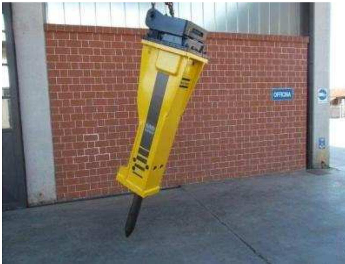
Martello demolitore idraulico
