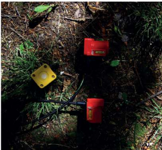
Figura 1.23. Tre geofoni (uno verticale, quello giallo, e due orizzontali tra loro perpendicolari) messi uno vicino all'altro. Un triassiale è di fatto una scatola in cui vi sono tre geofoni piazzati nello stesso modo e l'HVSR è solo uno dei molti utilizzi che se ne può fare
