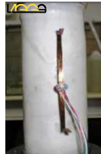
LDT montato su provino triassiale (UNICAS, Cassino)
