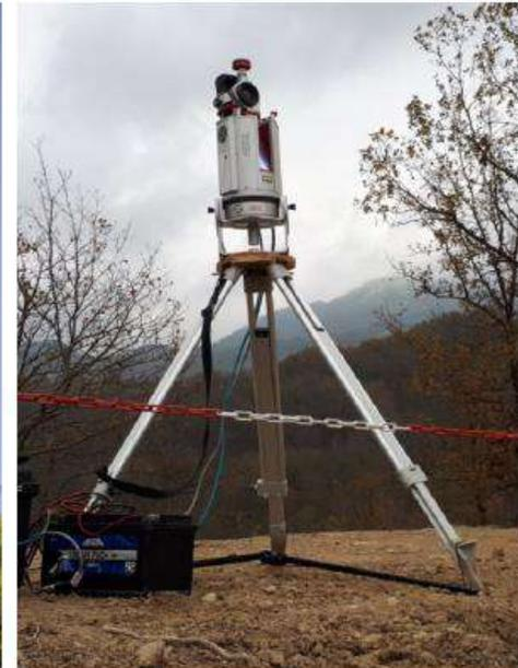
Tecnica di telerilevamento che permette di determinare la distanza da un oggetto con un impulso LASER. La strumentazione utilizza una lunghezza d'onda del visibile e dell'infrarosso vicino.
