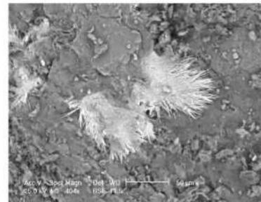
Associazione  $\text{Cu}_2\text{O} / \text{Cu}_2\text{CO}_3$
