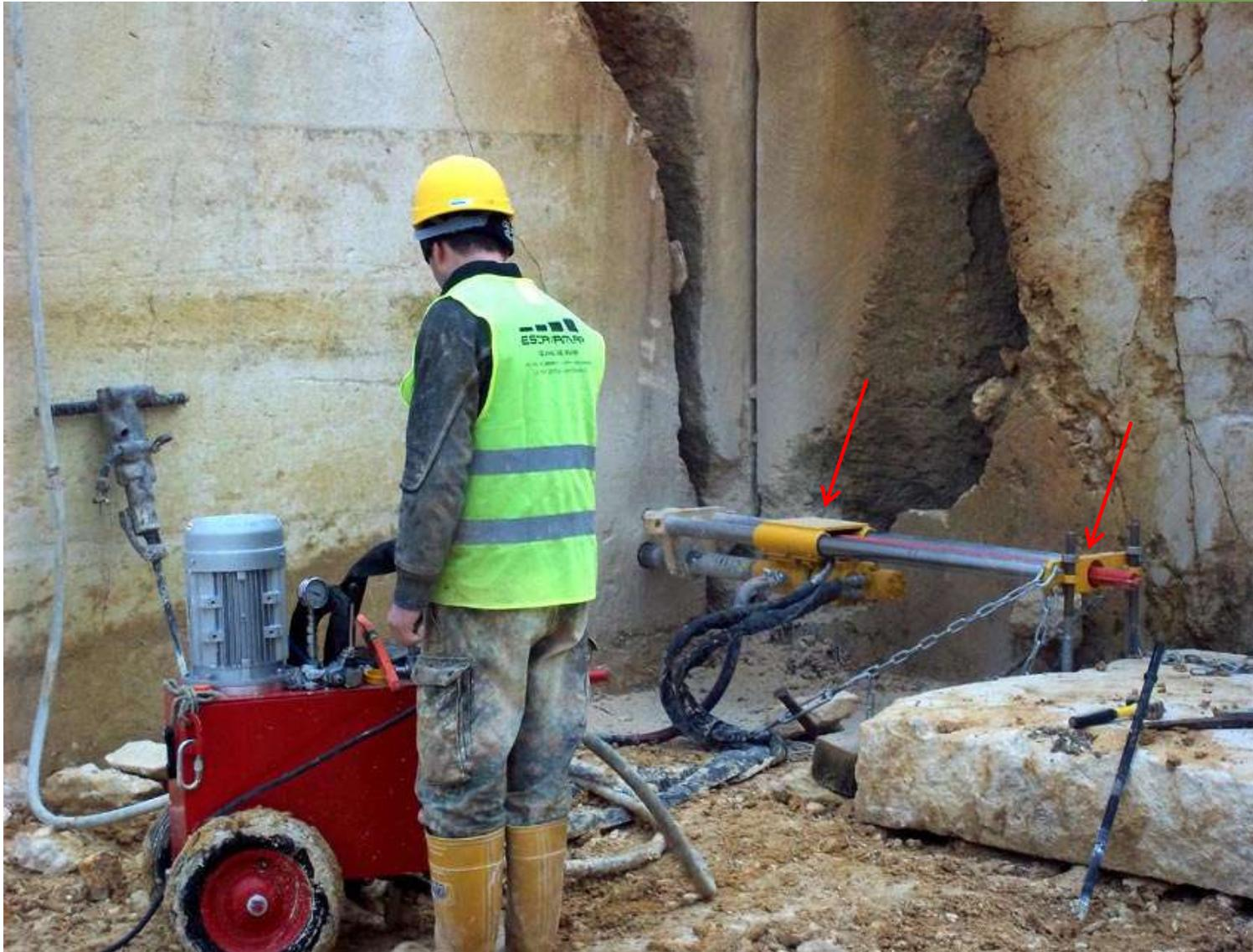
Perforatore idraulico servito da centralina elettrica
