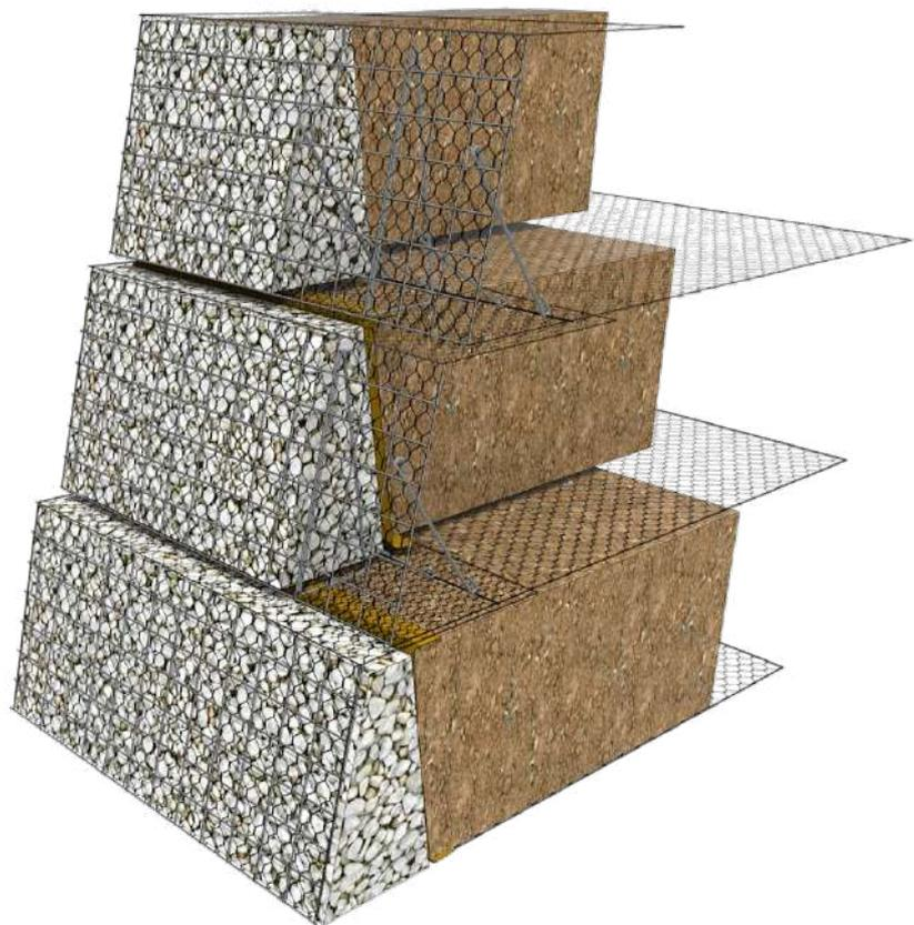
**TerraMesh Mineral** è un sistema unico di terre rinforzate con paramento inclinato in pietrame
