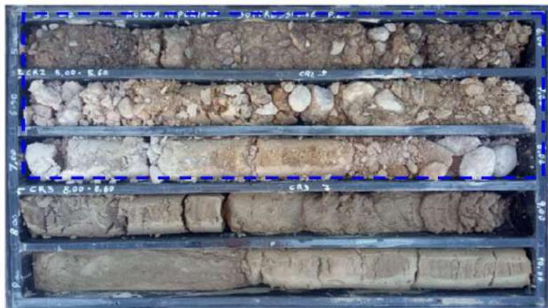
Figura 5-5 Foto della cassetta catalogatrice (S3 5.0-10.0 m), i depositi alluvionali costituiti da ghiaie sono evidenziati nel riquadro blu.
