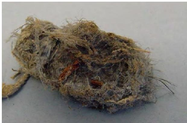
Figura 2: corda in amianto anfibolo crocidolite (foto S. Massera)
