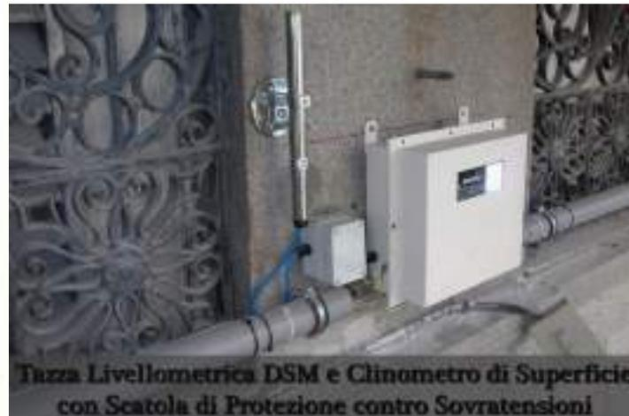
Tazza Livellometrica DSM e Clinometro di Superficie con Scatola di Protezione contro Sovratensioni
