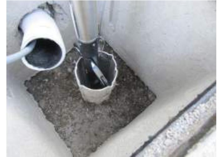
Negli Inclinatori a sonda mobile l'inclinazione è rilevata manualmente tramite una sonda periodicamente calata nel tubo installato permanentemente nel terreno.
