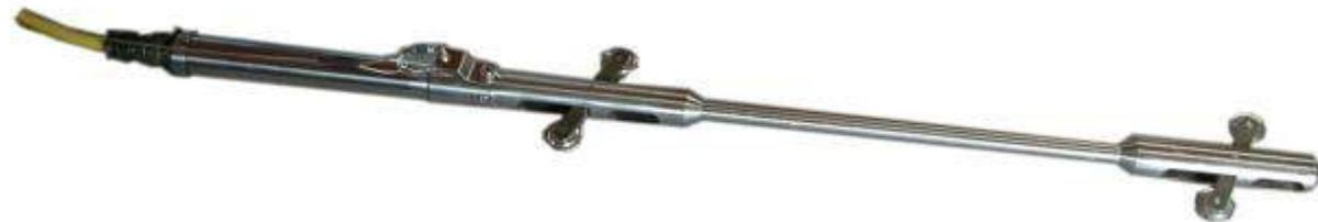
Un piezometro è costituito essenzialmente da una cavità, separata dal terreno da un setto poroso (filtro) di opportuna permeabilità, e da un sensore per misurare la pressione dell'acqua nella cavità. Il piezometro è inserito in una porzione di foro riempita di sabbia e isolata dal tratto restante mediante bentonite e cementazione
