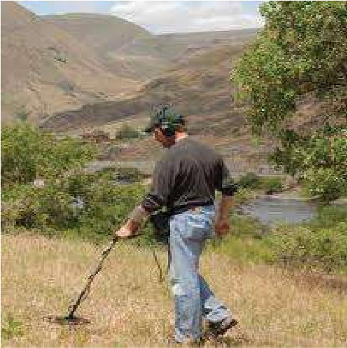
Invia un segnale elettromagnetico tramite una bobina: se un pezzo di metallo conduttore è vicino alla bobina, esso stesso produrrà un campo magnetico. Il metal detector “riceve” l’onda elettromagnetica emessa dall’oggetto tramite un’altra bobina ed emette un suono.
