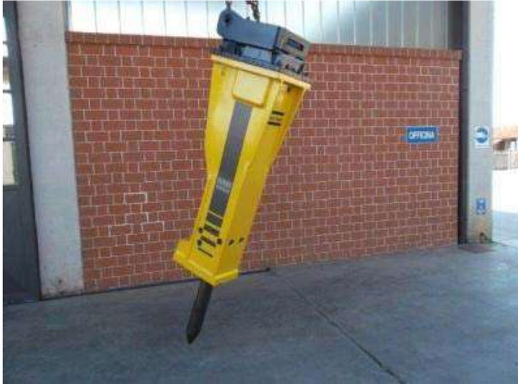
Martello demolitore idraulico
