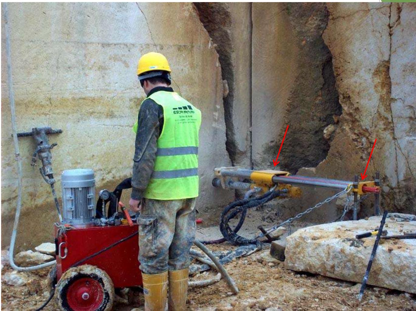
Perforatore idraulico servito da centralina elettrica
