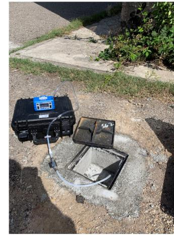
Pozzetto di estrazione ultimato e fase di campionamento del soil gas
