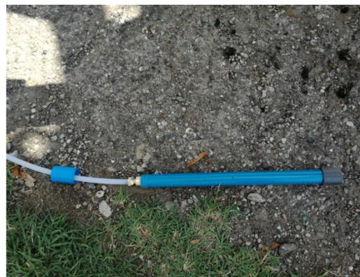
Cella filtrante e tubazione flessibile di collegamento con la superficie
