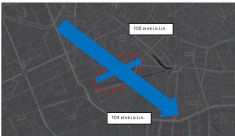
Per la definizione del modello concettuale sono necessari il gradiente idraulico e la direzione di deflusso della falda. Quest'ultima è necessaria anche per il posizionamento del punto di conformità
