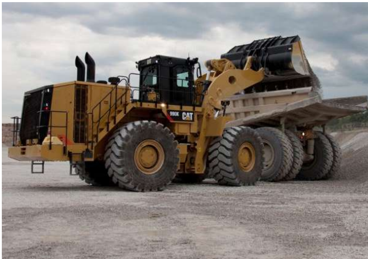
Pala gommata, armata con benna da carico 6 m 3
