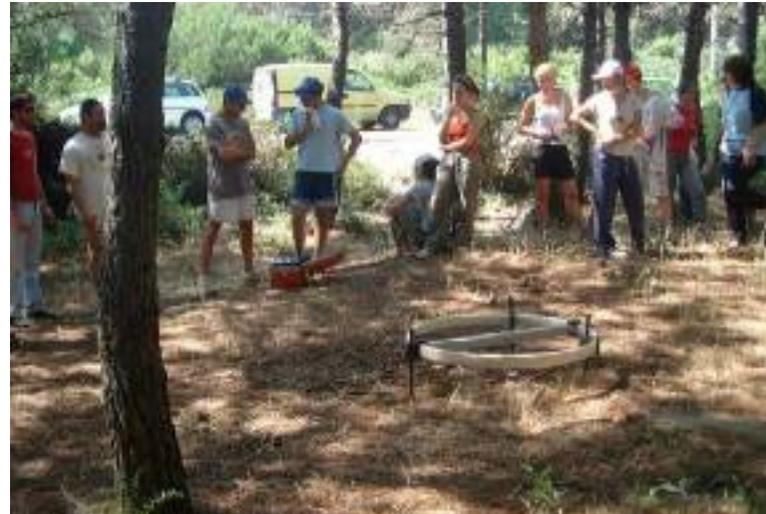
**Il coil ricevente mentre misura la componente verticale del campo magnetico secondario.**
