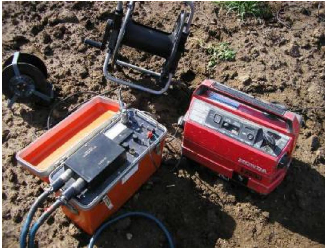
**Il Trasmettitore EM57 Geonics, alimentato da gruppo elettrogeno.
