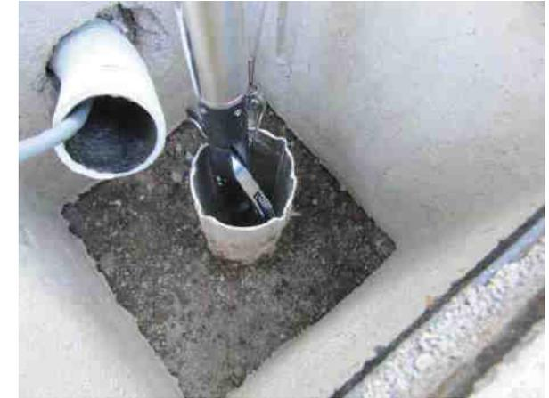
Negli Inclinometri a sonda mobile l'inclinazione è rilevata manualmente tramite una sonda periodicamente calata nel tubo installato permanentemente nel terreno.
