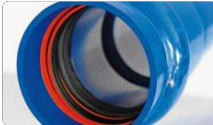
Guarnizione preinserita meccanicamente a caldo durante la fase di formazione del bicchiere.
