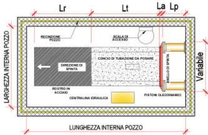
Fig.5 Ingombro pozzo di spinta spingitubo
