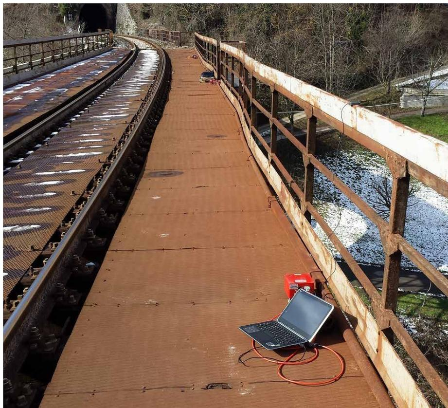
Fig. 5 - Misure dinamiche su ponte ferroviario.
