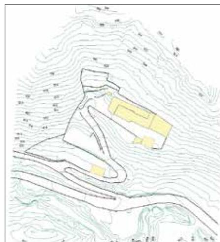
Fig. 15 - Esempio di restituzione aerofotogrammetrica.
