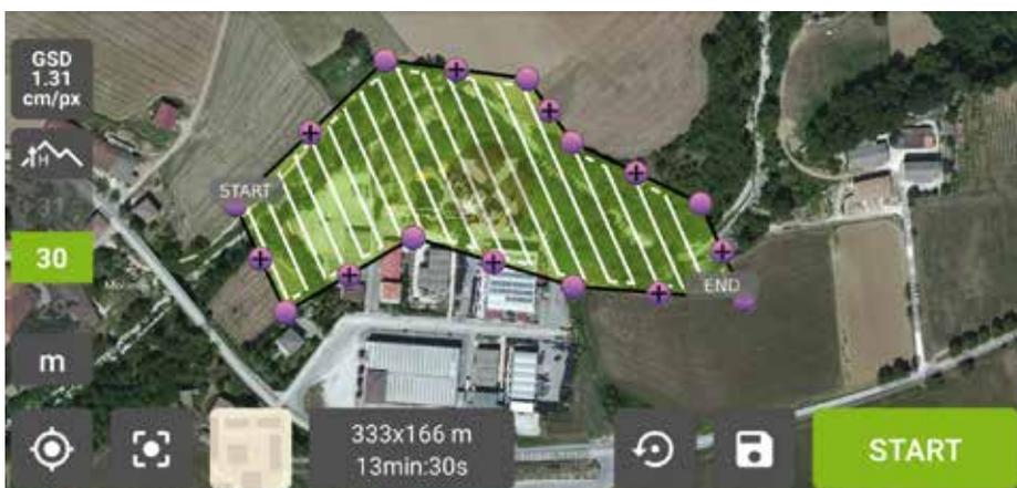
Fig. 4 - Esempio di piano di volo semplice lungo un'area poligonale con sovrapposizione di immagini del 70% e riprese a 30 m di quota.
