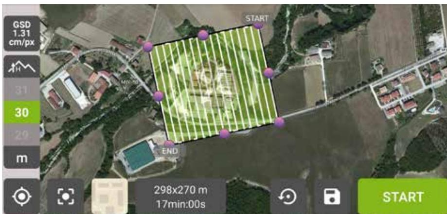
Fig. 3 - Esempio di piano di volo semplice con sovrapposizione di immagini del 70% e riprese a 30 m di quota, maggiormente indicato per i rilievi 2D, ma in molti casi questo tipo di piano di volo è sufficiente per generare un modello digitale del terreno apprezzabile.
