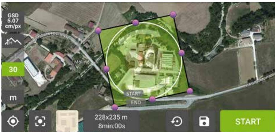
Fig. 5 - Esempio di piano di volo semplice lungo una traiettoria circolare con riprese fotografiche eseguite ogni 4° di angolo, generalmente indicato per modelli 3D di singoli elementi (torri, campanili, ecc.).
