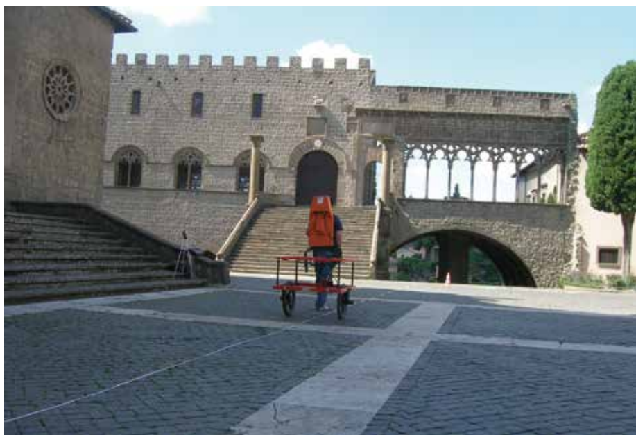
Fig 1 - Realizzazione prospezione TDEM
