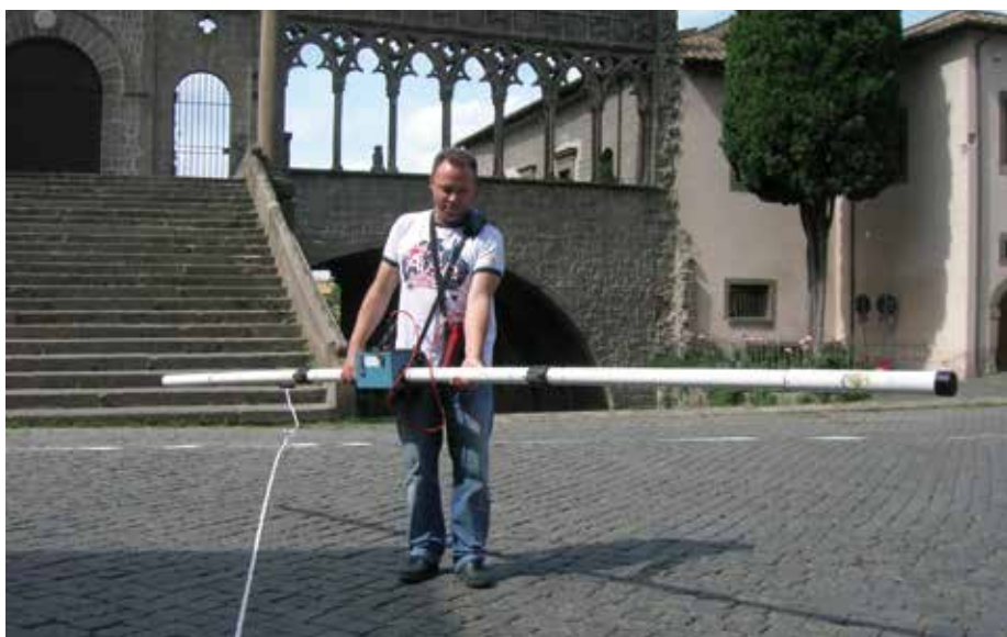
Fig3 - Realizzazione prospezione FDEM
