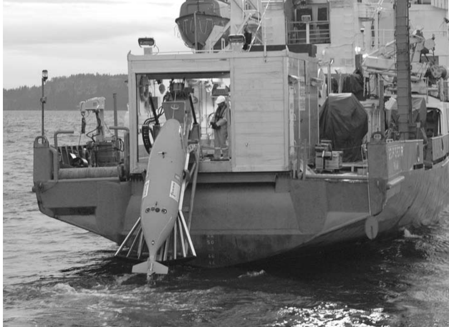
Sopra, fase di recupero del sistema AUV (Autonomous Underwater Vehicle) "Echo Surveyor" a bordo della nave MV Geo Prospector. A sinistra, nave per rilievi sismici 3D M/V Fugro Geo Arctic. Foto Fugro Oceansismica Spa.
